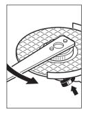
Een correct bevestigde, onbeschadigde snelspanmoer kunt u met de hand losdraaien door de kartelring tegen de klok (naar links) in te draaien. **Draai een vastzittende snelspanmoer nooit met een tang los, maar gebruik de combisleutel.** Zet de combisleutel aan zoals getoond op de afbeelding.
