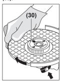
Pressione a tecla de bloqueio do veio (1), para bloquear o veio de retificação. Para apertar a porca de aperto rápido, rode o disco abrasivo para a direita com força.
